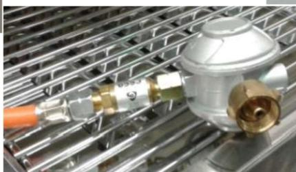
Cavagna Regler EN 16129/DIN4811 F1 mit ÜDS an einem Bräter. Schlauchlänge >0,4m, deshalb hier mit Schlauchbruchsicherung
